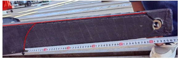
图7 航后方向破损情况 Fig. 7 Damage to reverse heading direction side
